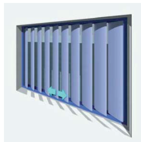
Parasoles y lamas: actuador de émbolo o cremallera
