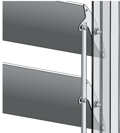
Conexión con pletina de aluminio
