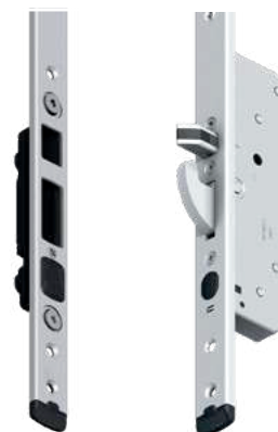
Cierre secundario automático tipo 10 con pestillo de cierre y pestillo de gancho de acero.
