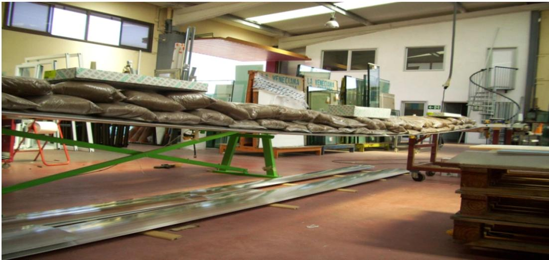
El montaje e instalación de la muestra de ensayo ha sido realizada por el peticionario sobre una estructura horizontal con pilares que fija la muestra a fin de conseguir un comportamiento en el funcionamiento de la lama similar al habido en las condiciones de instalación recomendadas por el fabricante.
