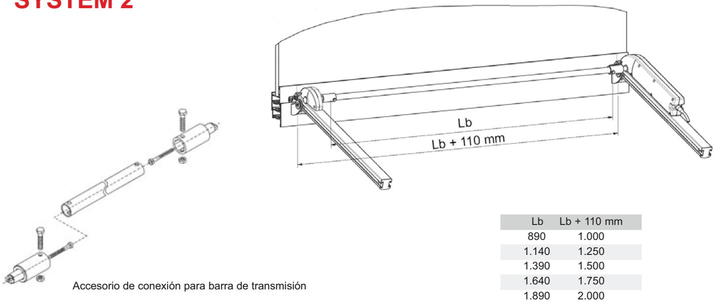
Accesorio de conexión para barra de transmisión
