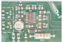
Final de carrera en cierre por absorción de corriente para evitar errores de posicionamiento del actuador
